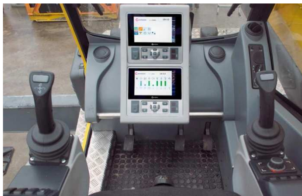
Nově provedená kabina jeřábníka s ovladačem jog-dial
