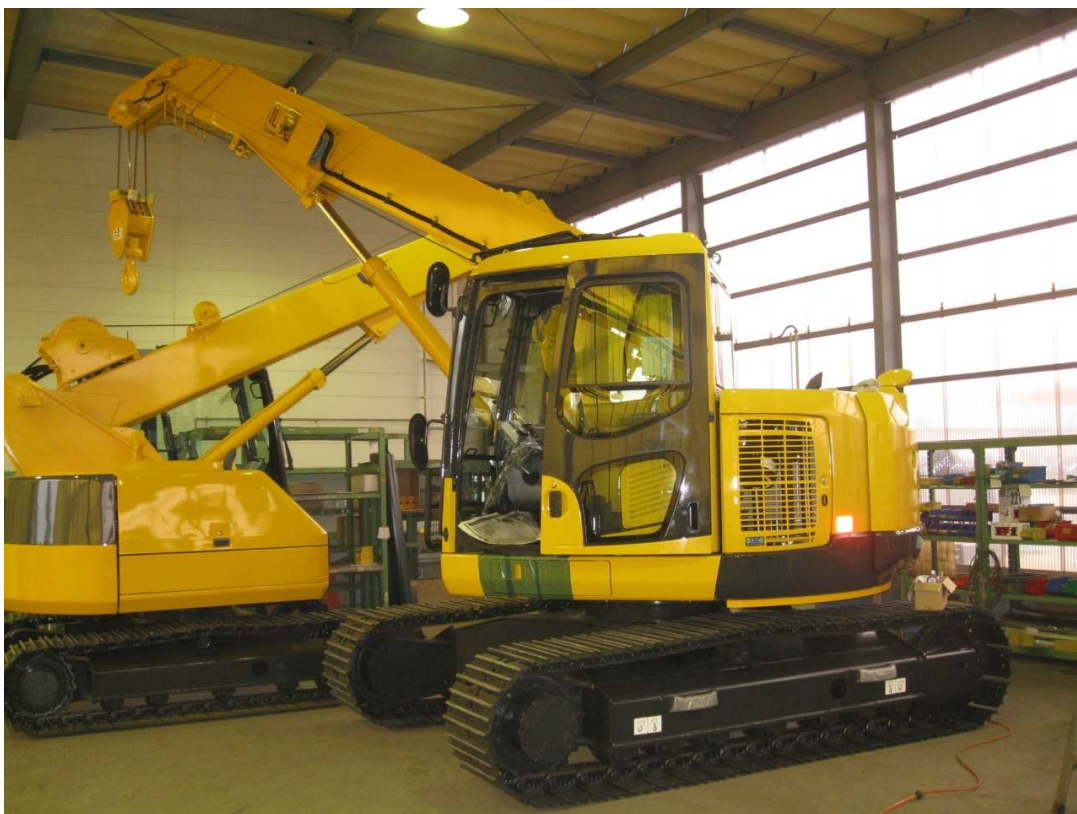
Celoprosklená a klimatizovaná kabina operátora.
