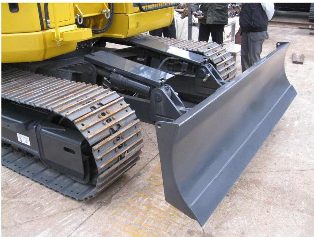
Jeřáb je sériově vybavený opěrnou radlicí
