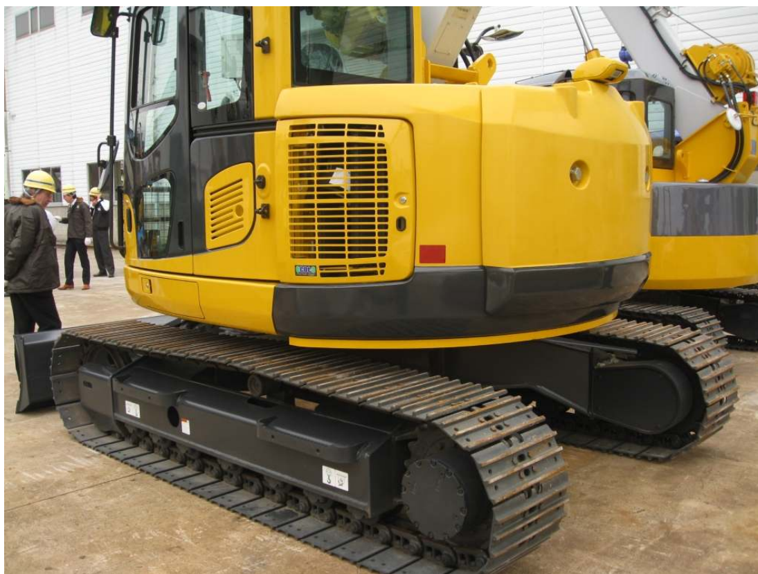
Jeřáb prakticky nemá boční přesah při otáčení. Zde je také vidět v zadu montovaná barevná kamera v pouzdře
