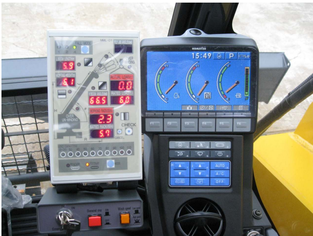
Detailní pohled na bezpečnostní zařízení MAEDA s omezovačem pracovního prostoru v kabině operátora a dotykový displej kontrolního panelu stavu jeřábu, na kterém se zobrazuje i obraz ze zadní kamery
