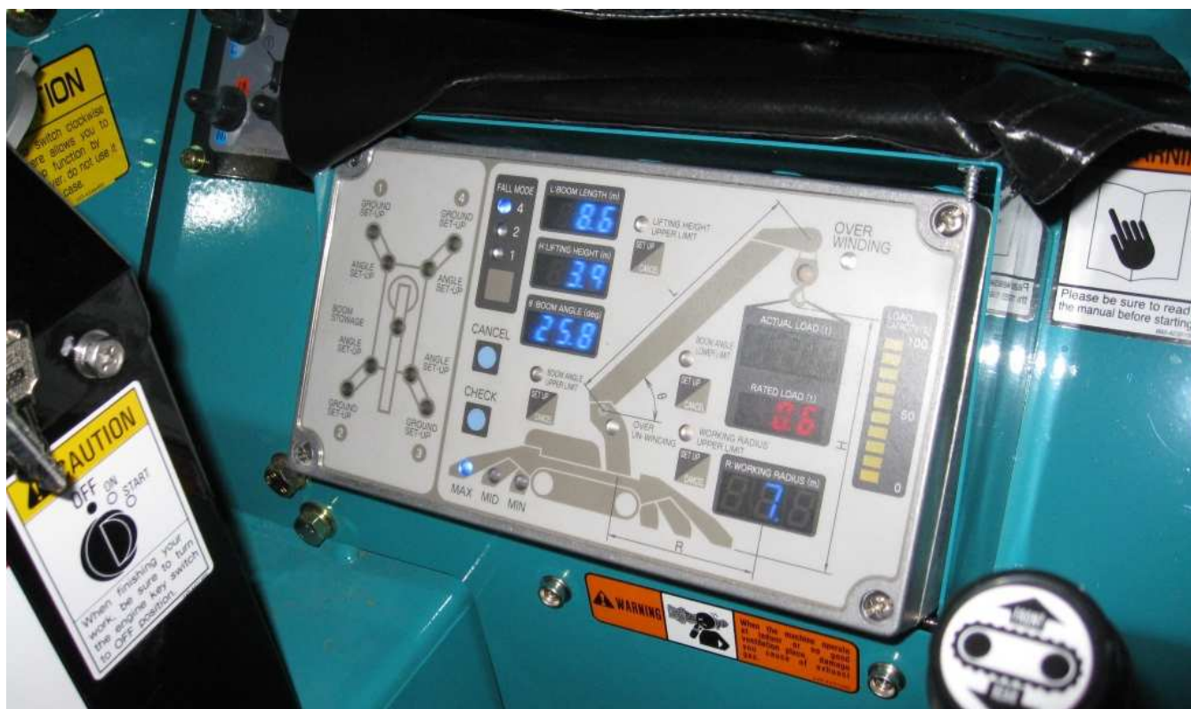
Detailní pohled na bezpečnostní zařízení MAEDA s omezovačem pracovního prostoru na malém jeřábu MAEDA MC305CRM-E-2
