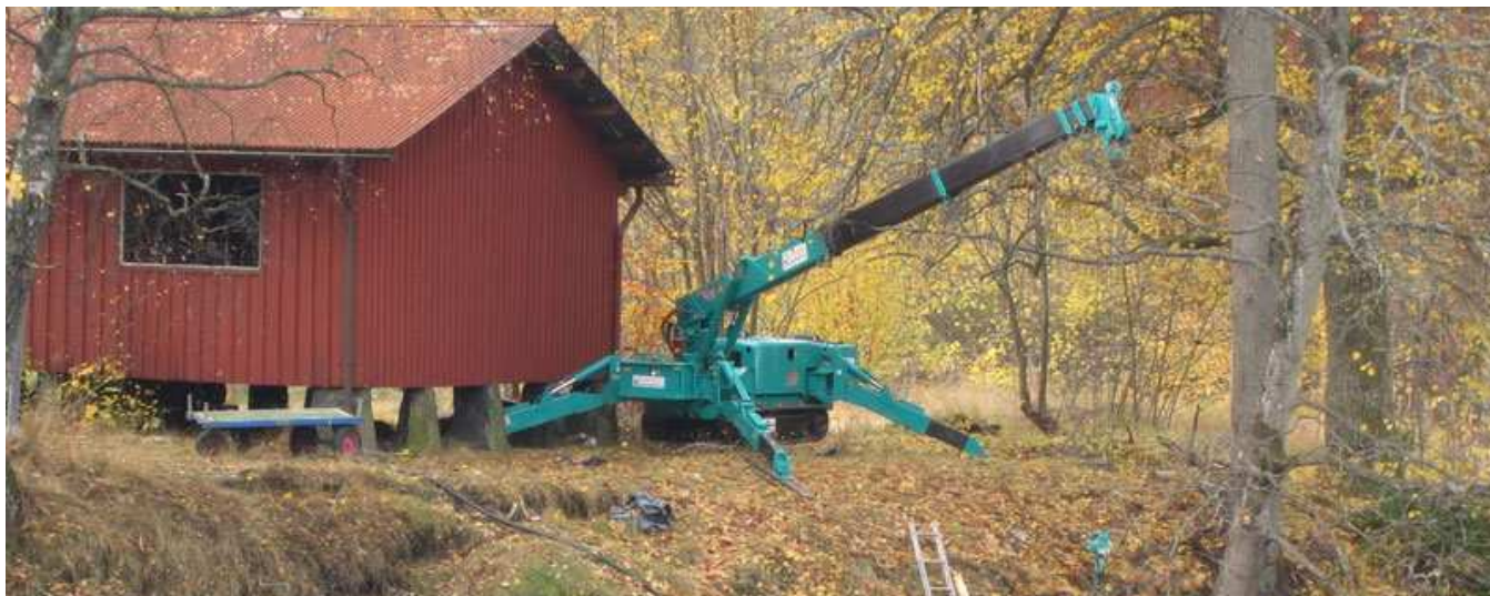
MAEDA MC305CRM-E-2 – malý pásový jeřáb s pohonem dieselovým a elektrickým motorem
